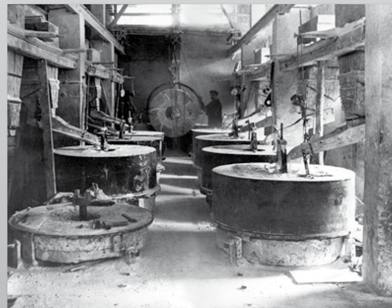
Reparto di macinazione della barite con il mulino a palmenti (o a pietra)
